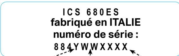
Y = Dernier chiffre de l'année de fabrication de la tronçonneuse
