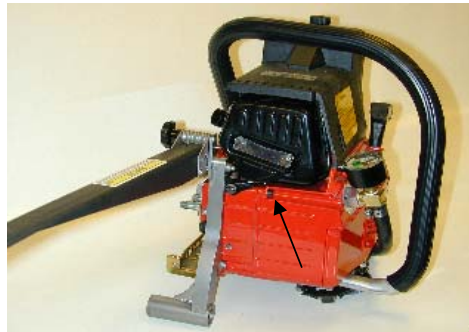
TRIN 6 Påsat lyddæmperstøttebeslaget igen. Kontrollér, at pakningen ikke er gledet ud af stilling. Påfør Loctite 242 (blå) på lyddæmperboltene og tilspænd med hånden.
