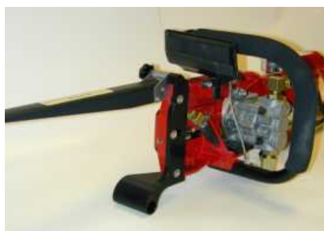
FASE 4 Collegare il supporto di montaggio dello SpeedHook®, non stringete eccessivamente i bulloni di collegamento. Il telaio della sega è di alluminio.
